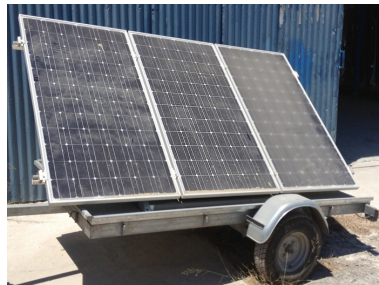
Φορητό ΦΒ στοιχείο μετά από έκθεση 6 μηνών σε φυσικό περιβάλλον. Η διαφορά του δεξιού στοιχείου (ατροποποίητο) με τα δύο πρώτα (SurfaShield G) είναι εμφανής.
